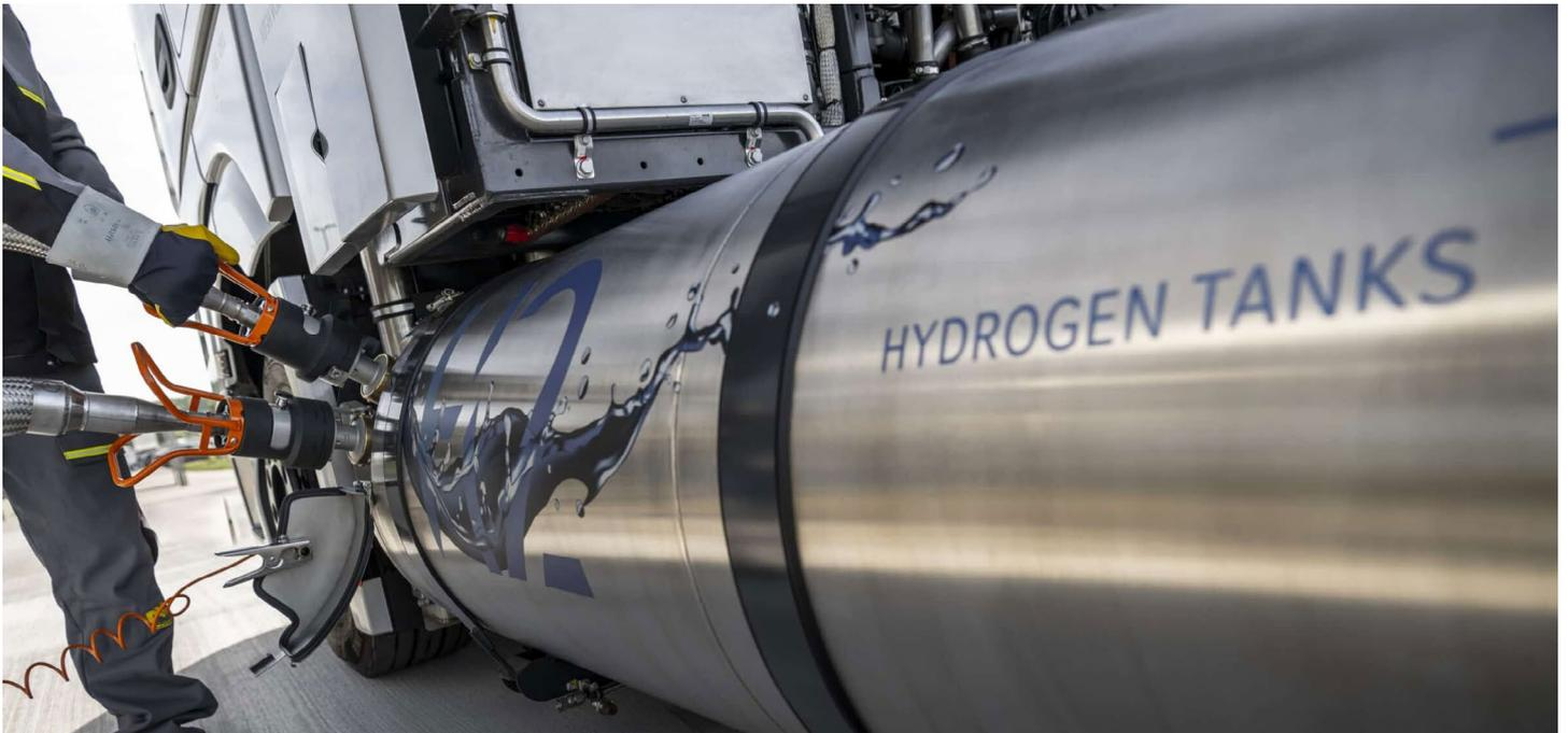
Betankung eines Brennstoffzellen LKW
